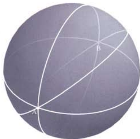
Figura 4. Dois círculos máximos interseçam-se sempre em dois pontos antípodos.
