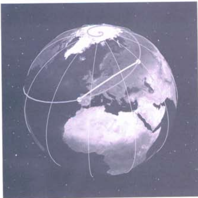
Figura 1. A cinzento escuro está representada uma curva loxodrómica que passa por dois pontos e a cinzento claro o menor arco de círculo máximo definido por esses pontos (caminho mais curto).
